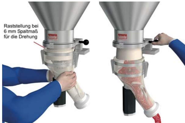
Fig. 4a: Drehen des Auslaufes in Entleerposition Fig. 4b: Absenken des Dosierers zur Schnellentleerung
