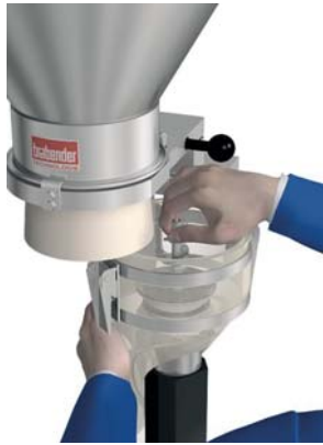
Fig. 6: Handgriff zum Schneckenwechsel bei Leistungsänderung
