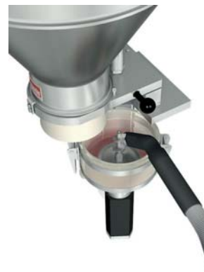
Fig. 5: Reinigung nach dem Aus-schwenken des Dosierers
