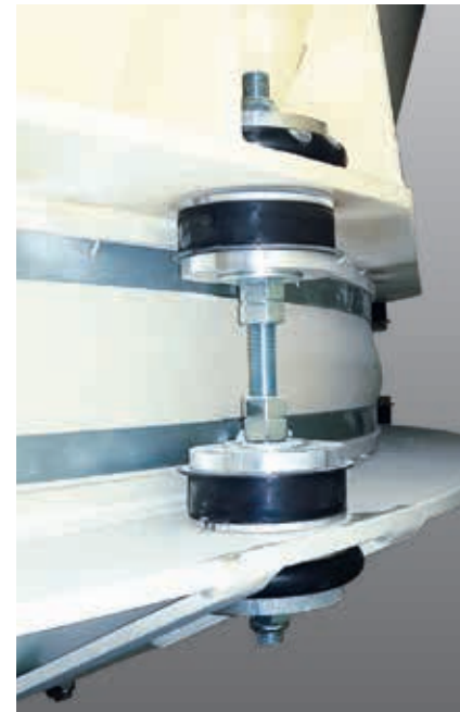
Die BAV lässt sich individuell an unterschiedliche Fließeigenschaften des Schüttguts beim Austragen oder Nachfüllen aus Behältern oder Silos anpassen. Im Detail: die Aufhängung aus dem Jahr 1989 der BAV Serie 02.
