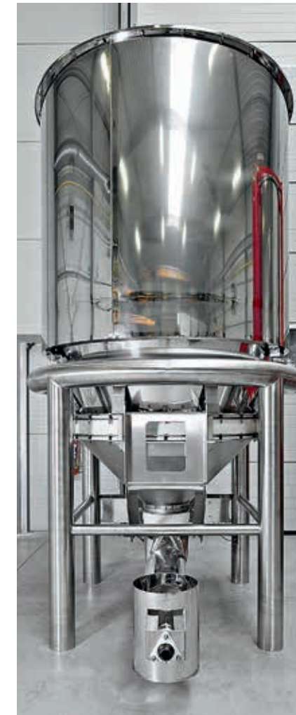
Lebensmittelkonforme Ausführung: Dosierdifferenzialwaage mit BAV 904 für den Einsatz im Food-Bereich
