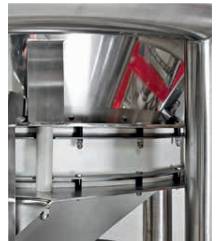
Lebensmittelkonforme Ausführung: Dosierdifferenzialwaage mit BAV 904 für den Einsatz im Food-Bereich
