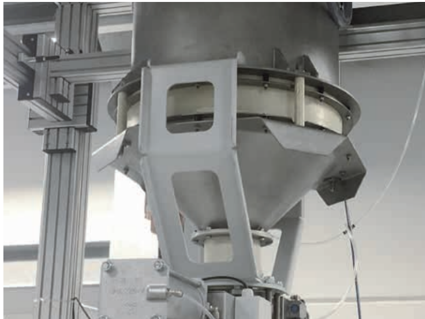
Die BAV lässt sich individuell an unterschiedliche Fließeigenschaften des Schüttguts beim Austragen oder Nachfüllen aus Behältern oder Silos anpassen. Im Detail: die Aufhängung aus dem Jahr 1989 der BAV Serie 02.
