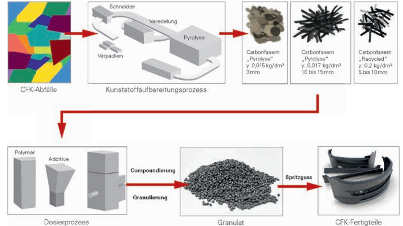
Recyclingprozess von Kohlenstofffaserrezyklaten mit Direktverarbeitung
