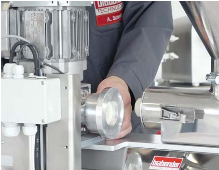
Bei der erweiterten Version verbleibt der Motor am Gerät und wird für eine Demontage lediglich verschoben, damit die Schnecke nach hinten herausgezogen werden kann.
