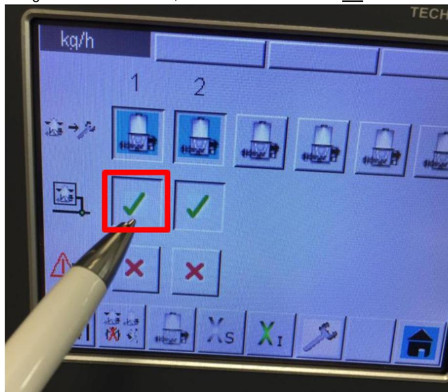
3. Schritt Das rote Kreuz bedeutet keine Kommunikation
