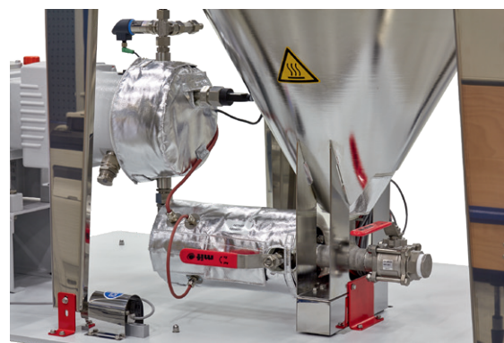
Elektrische Begleitheizung an Flüssigkeitsdosierer
