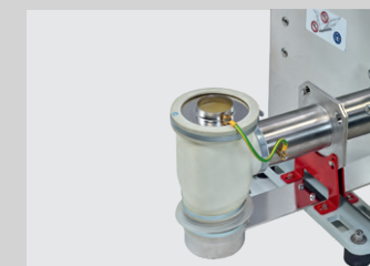
Erdung des vertikalen Auslaufs
