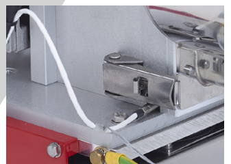
Temperaturfühler am Doppelwellengetriebe
